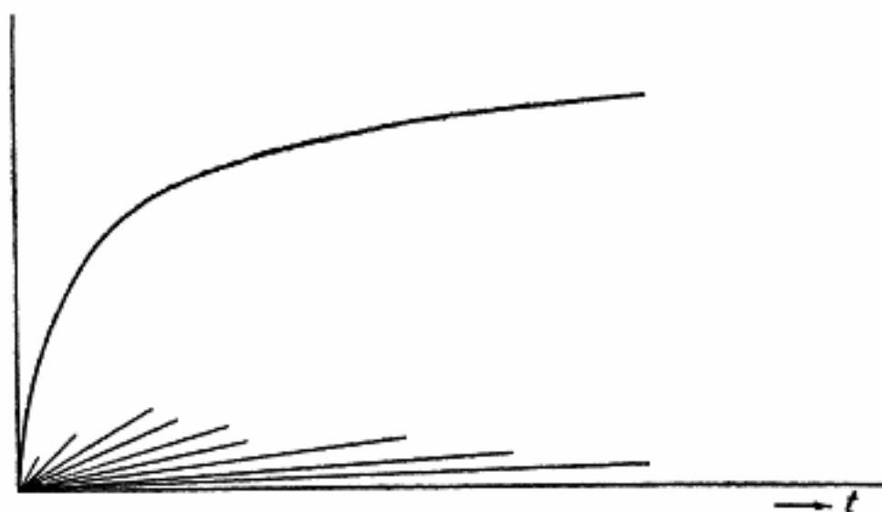
Рис. 19. Кривая оседания полидисперсной суспензии как результат совместного оседания большого числа монодисперсных фракций
