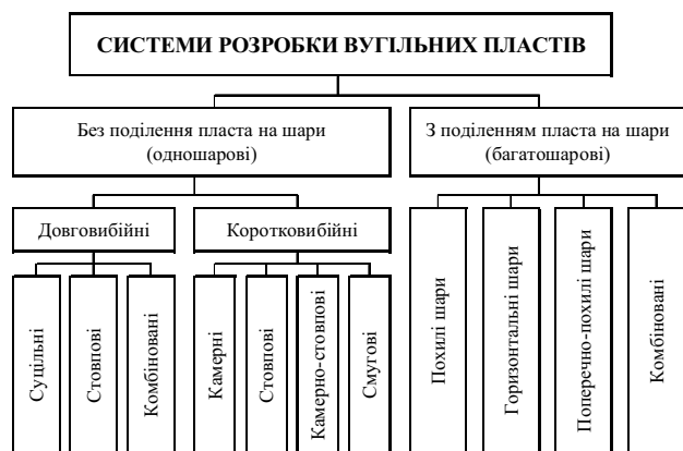
Рис. Спрощена класифікація систем розробки вугільних пластів
