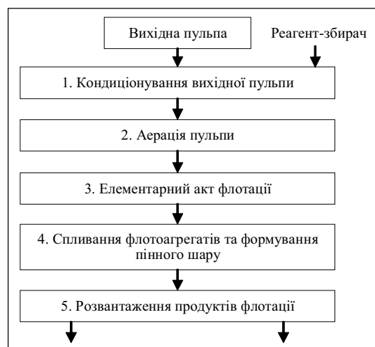
Рис. 1. Феноменологічна схема пінної флотації.
