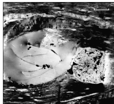
Рис. Секретиніт. Серед вітриніту (майже чорний), літтиніту (сірий), мікриніту (білий) чітко виділяються білі утворення - кулясте та кулясте - в центрі. Антрацит. Донецький басейн. Відбите поляризоване світло. Стан згасання. Шкала 0,02 мм. Фото Г.П.Маценко.
