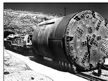
Рис. 3. Щитовий тунеліпрохідницький комплекс США, Невада, ренозитарій Юкка-Маунтин.
