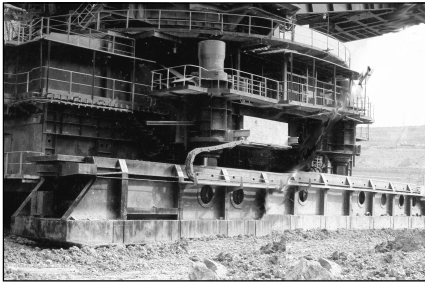
Рис. Крокуючо-рейкова ходова частина роторного екскаватора НКМЗ.
