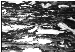
Рис. Тримацерит. Вітриніт (сірий), ліптиніт (чорний), інертиніт (білий). Львівсько-Волинський басейн. S_7 пласт n_7^o . Відбите світло. Імерсія. Шкала 0,02 мм. Фото Г.П.Маценко.
