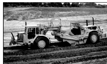
Рис. Скрепер колісний 627 Е потужністю 414,2 кВт фірми "Катерпілар" (США).
