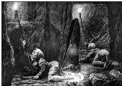
Рис. Випалювання метану в покрівлі виробки. Реконструкція (ш. Велічка, Польща).
